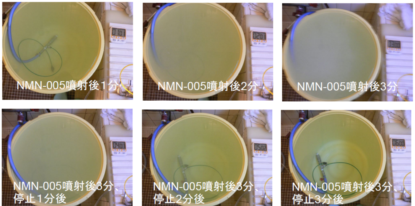
写真2 「ナノ・ミキサー」による“負圧マイクロ・バブル”発生例
